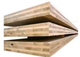
CLTとはCross Laminated Timberの略称で、ひき板（ラミナ）を並べた後、繊維方向が直交するように積層接着した木質系材料です。
